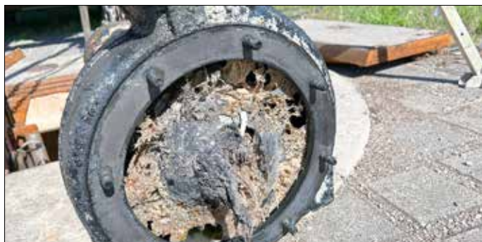
Verstopfte Pumpe in der Abwasserleitung Reibitz
