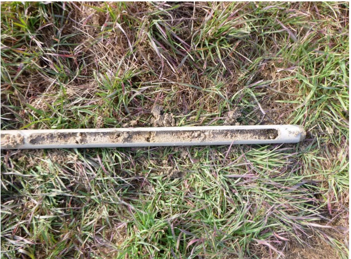
Bild 6: Bohrung 7, Mittelsand, stark grobsandig, tieferer Bereich bei 4,5-5,0 m.
