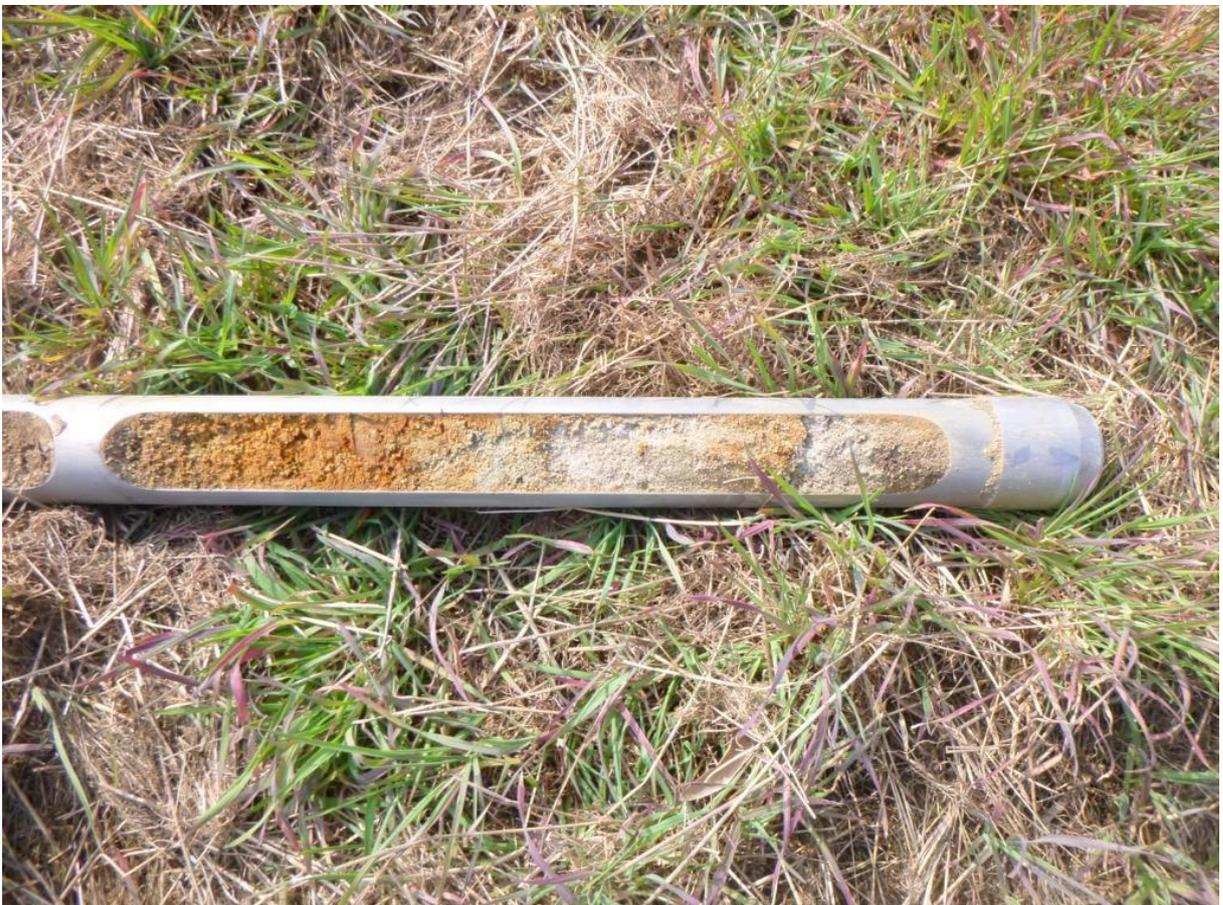
Bild 4: Bohrung 1, Grobsand, stark feinkiesig, Bereich bei 0,5-1,0 m.
