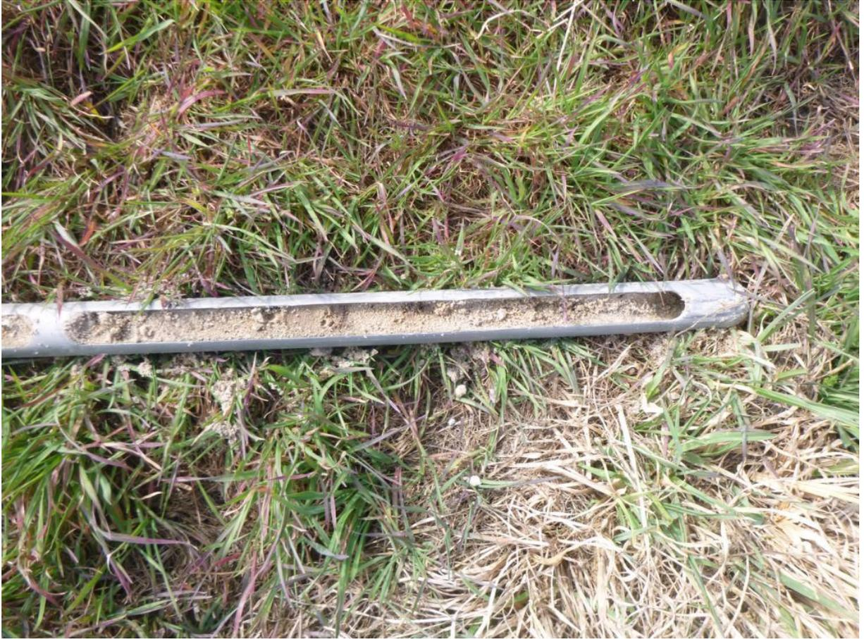
Bild 5: Bohrung 2, Mittelsand, stark grobsandig, schwach feinkiesig, Bereich bei 2,5-3,0 m.
