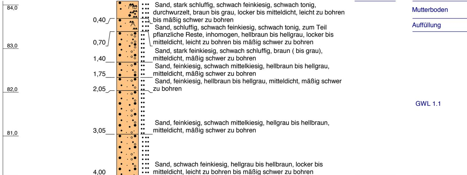
Bemerkung: Bohrloch offen bis -4 m; trocken nach Beendigung der Bohrung
